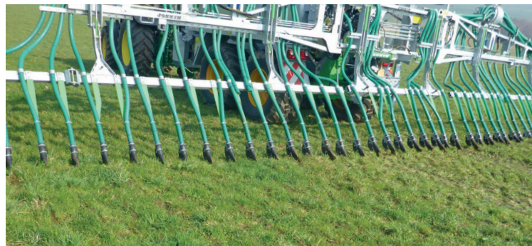
Le pendislide de Joskin équipé de patins permettant de déposer le lisier sous forme de boudin au pied de l'herbe.
